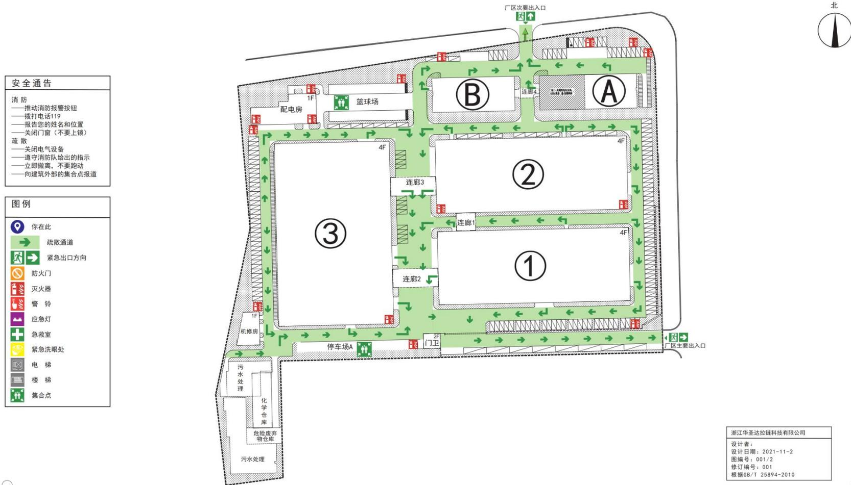
图 7-2 厂区应急设施分布图、厂区内疏散路线图
